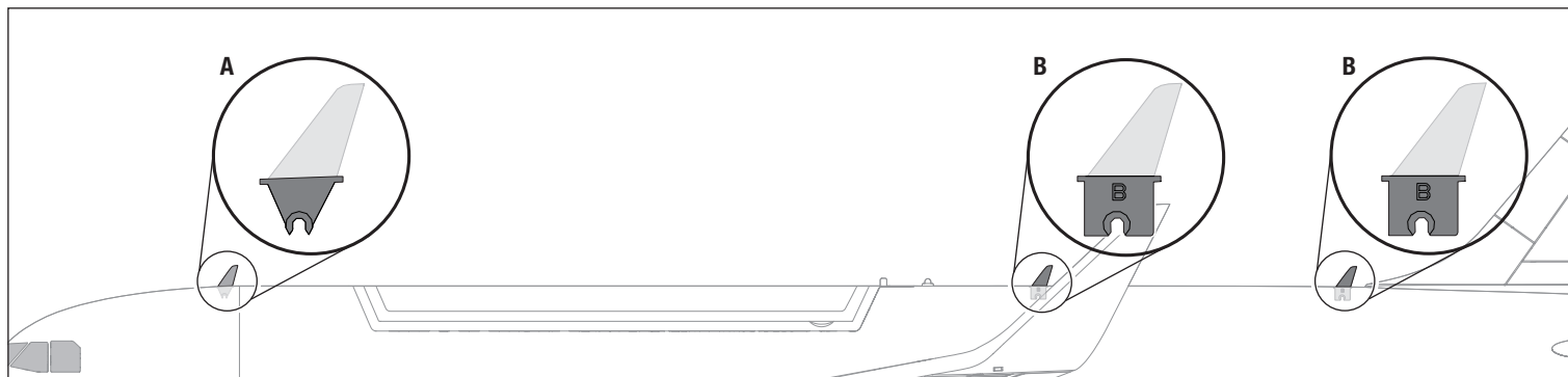
Emplacement de stockage de l'antenne factice
