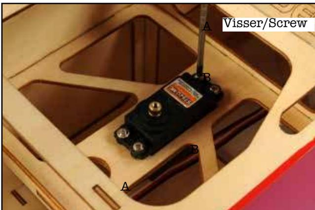
9) Visser le servo de direction dans son logement sur la platine dans le fuselage.
