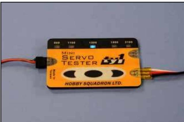
11) Mettre le servo d'aileron au neutre à l'aide d'un servo tester (#0435051).
