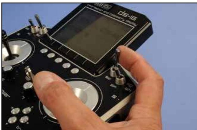
15) Un simple inter 3 positions sera parfait pour actionner les volets : position Volets rentrés...
