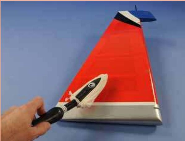
2) En utilisant un fer à solar et un chiffon doux, "repassez" délicatement et "suivez" en appliquant le film avec le chiffon. Si des bulles apparaissent, votre fer est peut être trop chaud. Réduire la température et travaillez doucement et patiemment.
