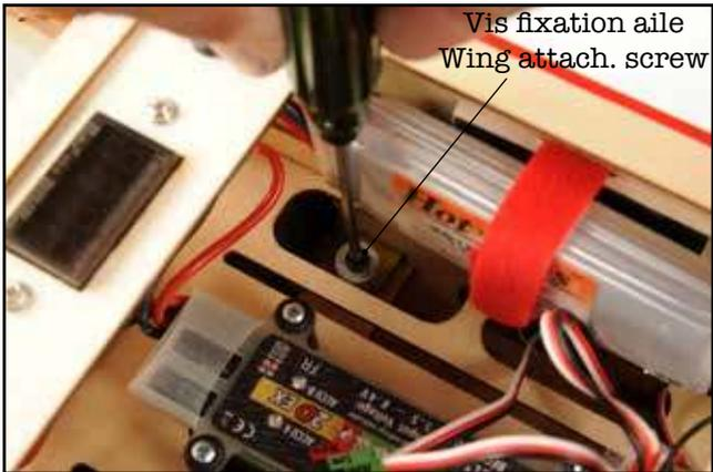
20) Les accus de réception sont fixés de chaque côté du fuselage à l'aide de Velcro® et sangles. Attention! Ils ne doivent pas gêner l'accès aux vis de fixation des ailes.
