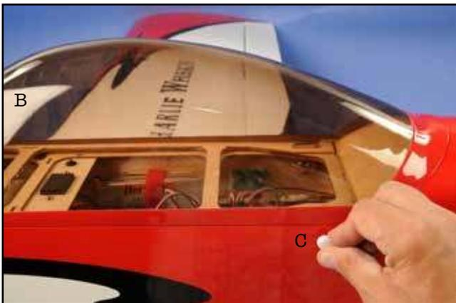
21) La verrière B est maintenue par deux tétons en plastique à l'avant (dont il convient de vérifier le collage) et les deux vis C avec tête plastique moletée à l'arrière.
