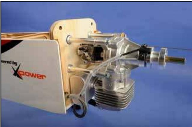
10) Percez dans la cloison pare-feu le passage pour le capuchon de bougie et le fil du capteur puis une fois ceux-ci connectés...
