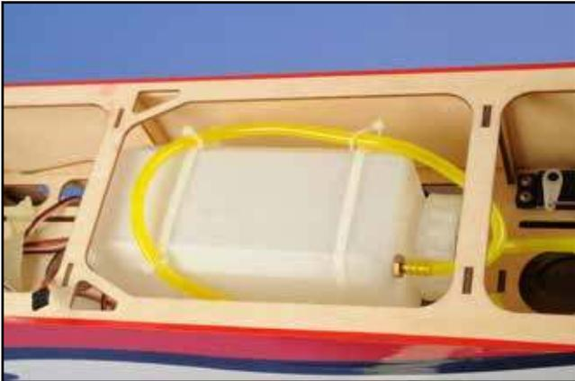
12) Fixer le réservoir au plus près du CG, juste devant la clé d'aile à l'aide de colliers rilsan (non fournis). Ne pas oublier de faire un tour mort au trop au dessus du réservoir pour éviter le siphonnage.
