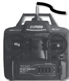
2. K ovladači připevňte malou větrnou pásku a vytáhněte anténu na maximum – není nutné u vysílačů 2.4 GHz.
