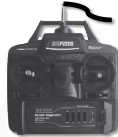
2. Fixer un petit ruban volant à l'antenne de votre télécommande et déployez entièrement l'antenne - pas nécessaire avec les émetteurs 2,4 GHz.
