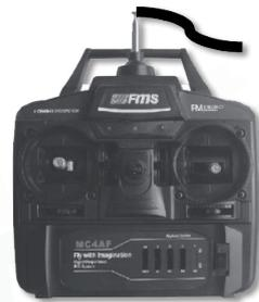
2. Attaccate un piccolo nastro a vento all'antenna del vostro radiocomando ed estendete completamente l'antenna - non è necessario con i trasmettitori a 2.4 GHz
