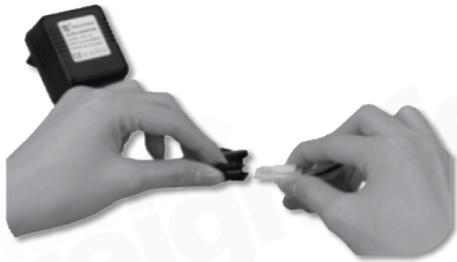
1. Caricate la vostra batteria di volo con un dispositivo di carica adatto. **ATTENZIONE:** Non lasciare la batteria incustodita per evitare intromissioni da terze parti.
