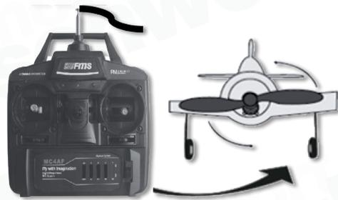
5. Premete brevemente ed attentamente il controllo della manetta sul vostro radiocomando e l'elica inizierà a ruotare.
