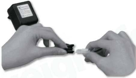
1. Chargez votre batterie de vol avec un appareil de charge adaptée. ATTENTION : Ne laissez pas la batterie sans surveillance pour éviter une utilisation par des tiers.
