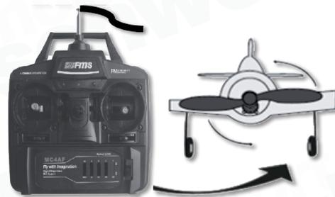
5. Appuyez sur la commande d'accélérateur de votre télécommande brièvement et soigneusement et l'hélice commencera à tourner.
