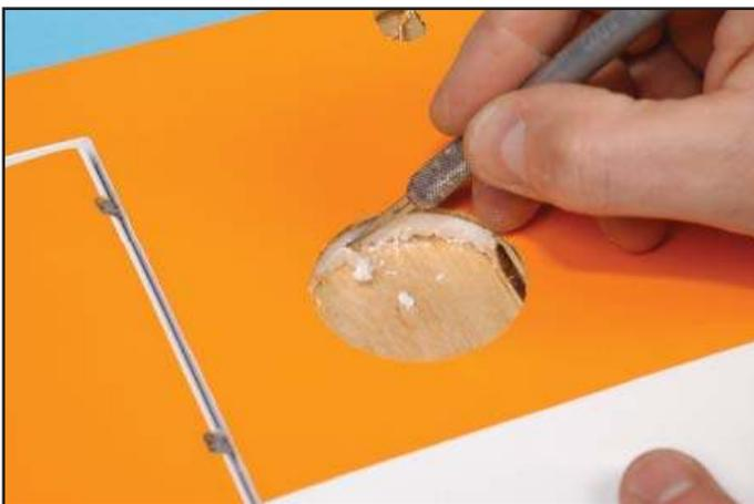
● Creuser légèrement le polystyrène dans le puit du servo de volet
