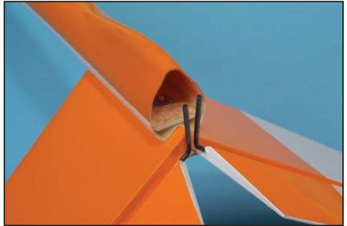
● Monter le stab sur le fuselage avec les 2 vis M3x20 3-4.
