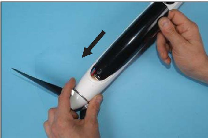
● Pour fixer la verrière, glisser la CAP avant dans le fuselage...
