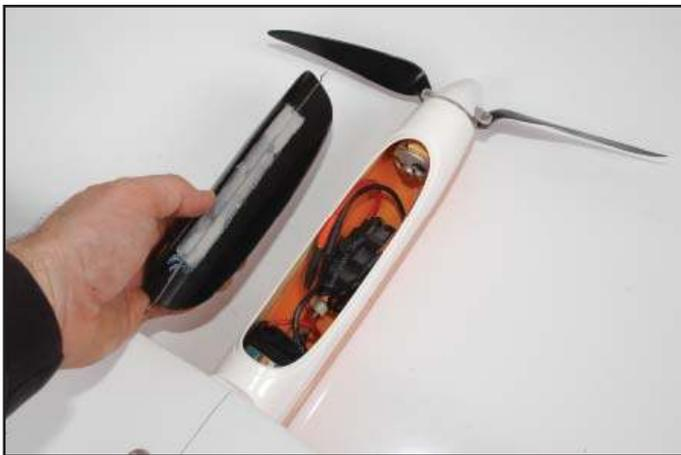
● Positionner la CAP au centre de la cabine 6 comme sur la photo, puis poser le ruban de tissu de verre dessus. Appliquer de la colle cyano fluide sur la fibre de verre jusqu'à ce que la CAP soit parfaitement immobilisée.
