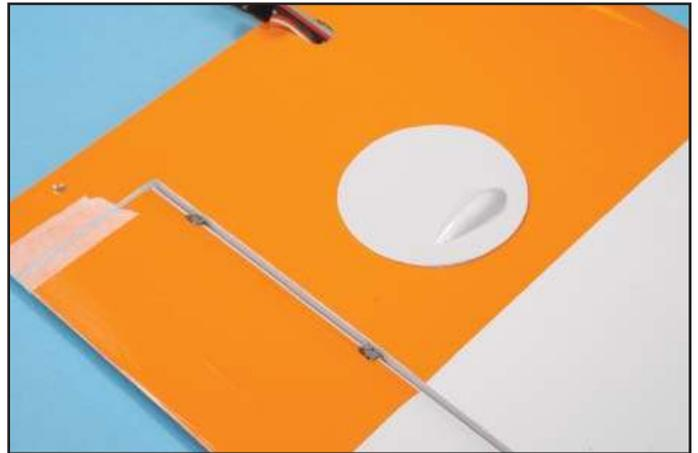
Notez la position du carénage de volet 2-41F. La commande doit débattre librement sans toucher le carénage.
