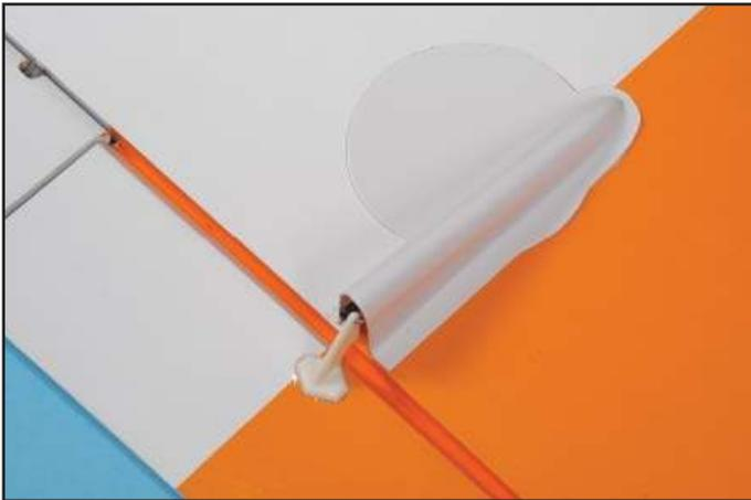
Notez la position du carénage d'aileron 2-41A. La commande doit débattre librement sans toucher le carénage.
