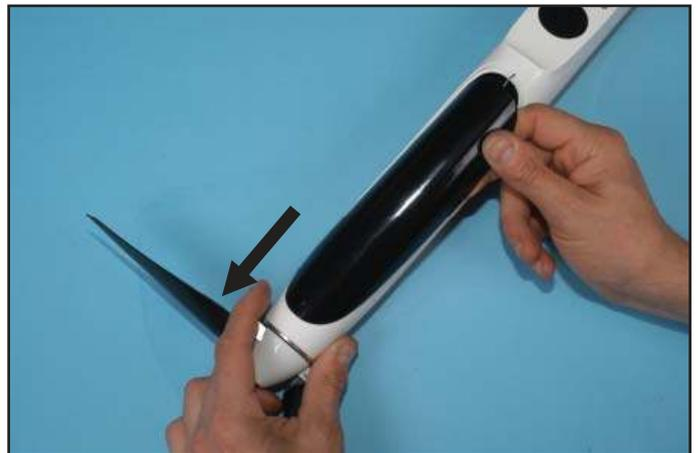
...avancer la cabine au maximum vers l'avant jusqu'à pouvoir glisser la CAP arrière dans le fuselage...
