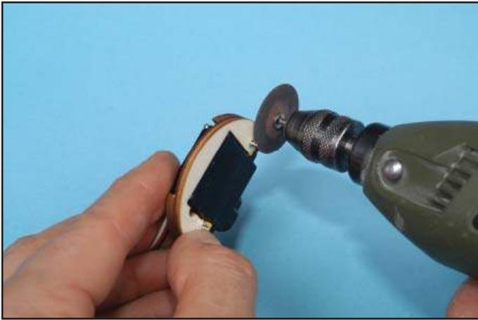
● Arraser les vis à bois de façon à ce que la platine puisse reposer à plat sur le coffrage à l'intérieur de l'aile.
