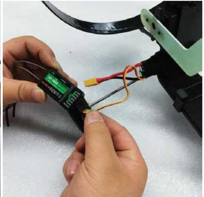
**Étape 16 :** Fixez votre récepteur au boîtier de servo avec la bande adhésive à crochet et boucle arrière. Sécuriser et ranger le servo fils et antenne du récepteur à l'aide de serre-câbles.
