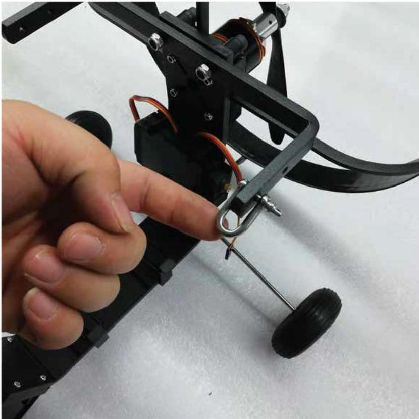
**Étape 14** : Insérez les manilles dans les trous extérieurs, soit côté de la flybar.
