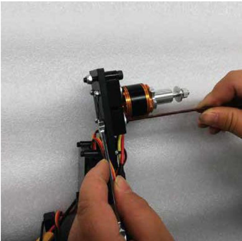
**Étape 5 :** À ce stade, nous devons retirer le moteur et le support moteur. La raison en est que les bras de soutien en aluminium proppuard doivent être installé derrière eux.
