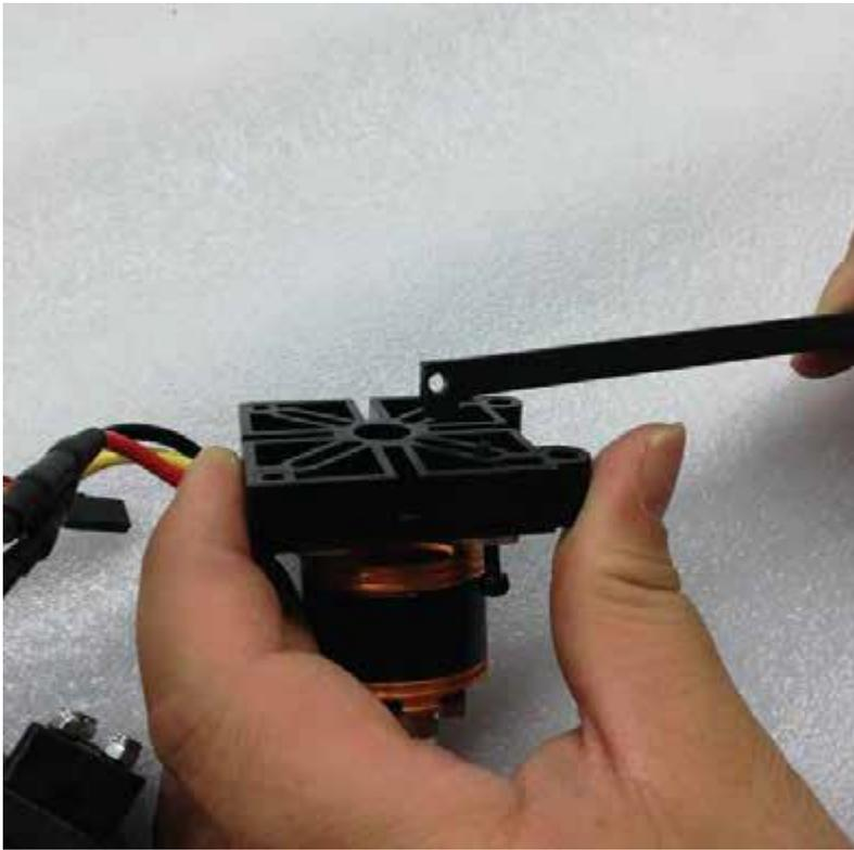
**Étape 6** : Poussez les vis hexagonales à travers et retirez le moteur et démontez complètement le moteur, cela facilite la pose des supports.
