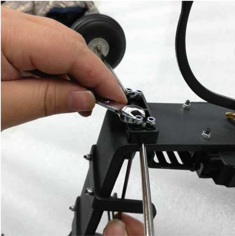
**Étape 4 :** Remettez les écrous nylstop et serrez l'ensemble.
