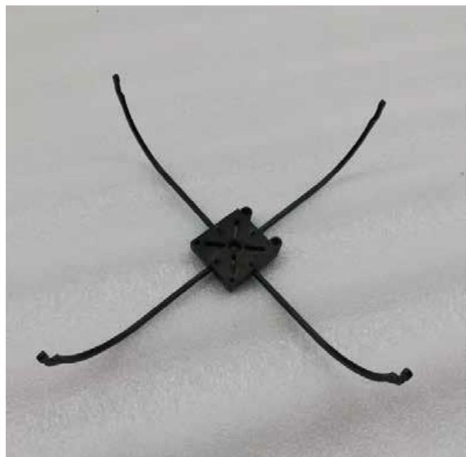
**Étape 7** : Clipsez les 4 bras de support de la garde d'équerre dans les fentes à l'arrière du support moteur. Ceux-ci peuvent être à ajustement serré, vous auriez besoin de les presser avec une pince ou un outil similaire.
