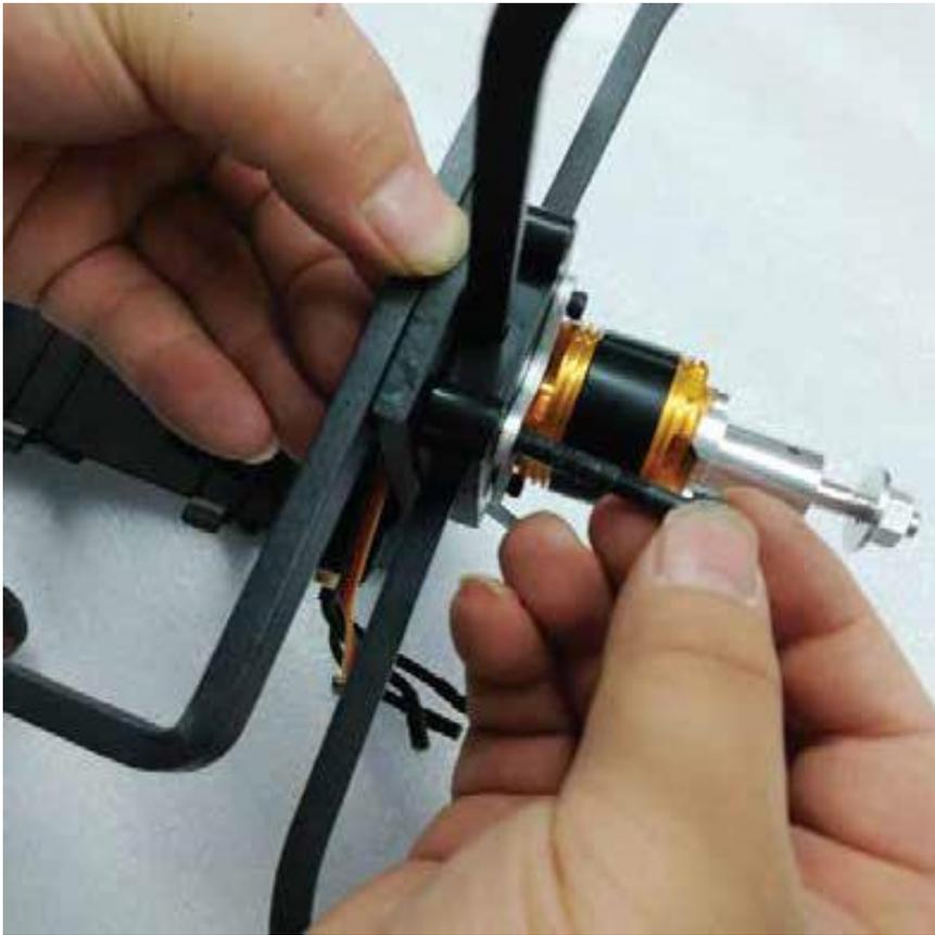
**Étape 9** : Installez le flybar à l'avant de la cellule en utilisant les plus longs boulons à travers les trous supérieurs du support moteur.
