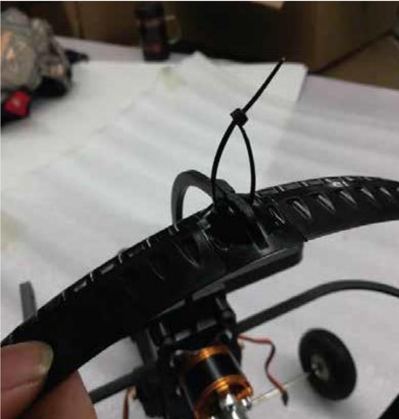
Faites ceci sur les 4 supports et serrez les attaches de câble pour sécuriser la garde d'hélice.
