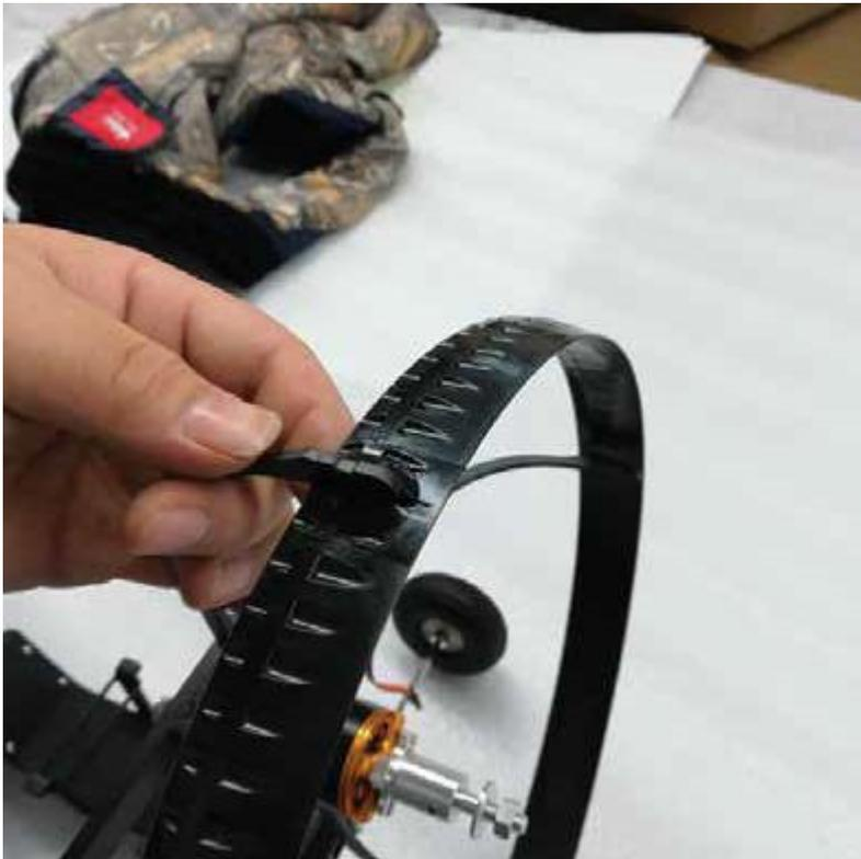
**Étape 10 :** Attachez les 4 supports de protection d'hélice dans les fentes situées Sur le gardien d'hélice.
