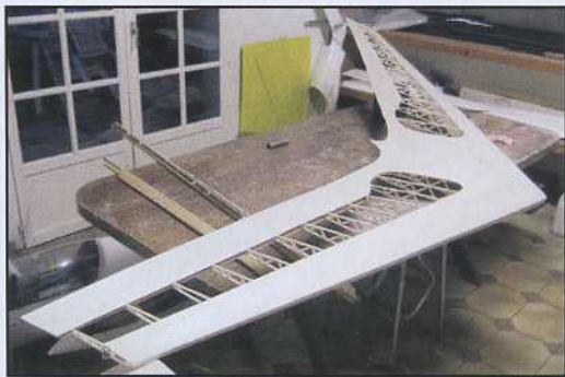
La structure de l'aile est bien avancée, et l'allure "Horten" est bien présente.
