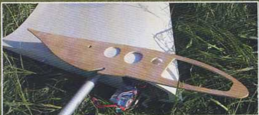
L'aile se démonte, ce qui rend le transport aisé, et on accède au récepteur et à l'accu par cette ouverture dans les nervures centrales.
