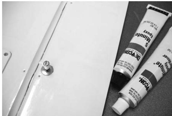
Die Anlenkklasche sollte mit ca. 23 mm Hebelarm auf die M3 Schraube aufgedreht sein. Nach dem Trocknen des Klebstoffes, Gabelkopf in Servohebel einhängen, die Länge der Gestänge anzeigen und mit der Zange Best.-Nr. 5732 z-förmig abbiegen. Gabelkopf aushängen, Gestänge in Anlenkklasche, und Gabelkopf wieder in Servohebel einhängen.
