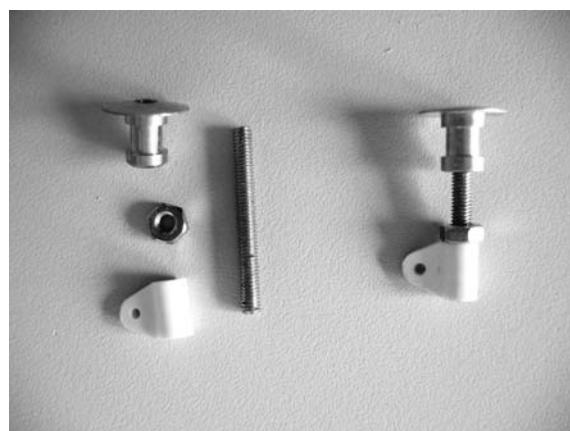
Nach dem Trocknen des Klebstoffes Gabelköpfe in die Anlenkklaschen einhängen. Entsprechend dem Foto die Gestänge an den Servos anschließen.
