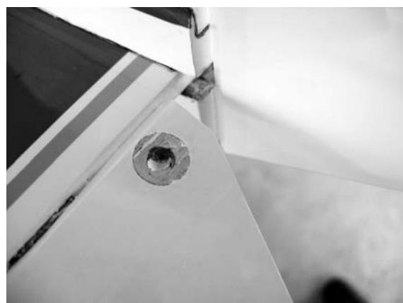
Bei den beiden Höhenrudern von oben, bei dem Seitenruder von rechts die Ruderhornbuchse in die Ruder kleben. Nach dem Trocknen des Klebstoffes die Gewindestange, Mutter und Anlenkklasche aufdrehen.
