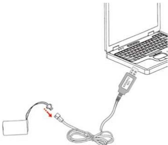
Verbinden Sie das USB-Ladekabel mit einer USB-Buchse an einem PC, Laptop oder Smartphone Ladenetzteil. Schließen Sie dann den Flug-Akku am Ladekabel an.
