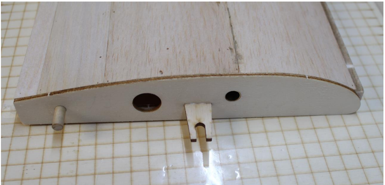
Verdrehbolzen (Buche \text{\O}6 \times 30 mm) und Halter für Tragflächenverschraubung (A2) in Wurzel- bzw. Deckrippe (I3) verleimen
