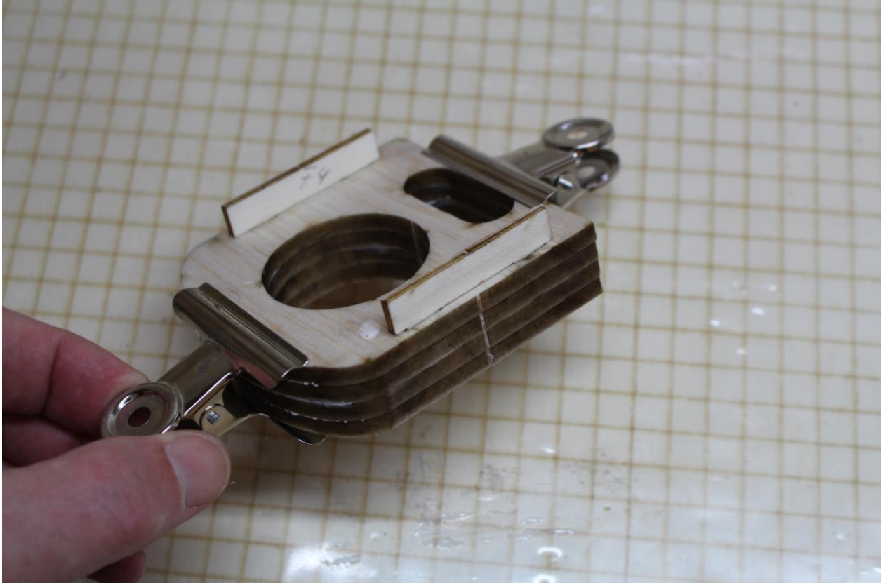
Frontverkleidung mit 3× (G) ergänzen und verleimen Hinweis Frontverkleidung nicht mit dem Rumpf verleimen, wird später nur verschraubt
