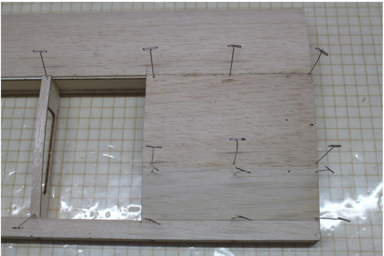
Wurzelbeplankung (1,5-mm-Balsa) zuschneiden und verleimen
