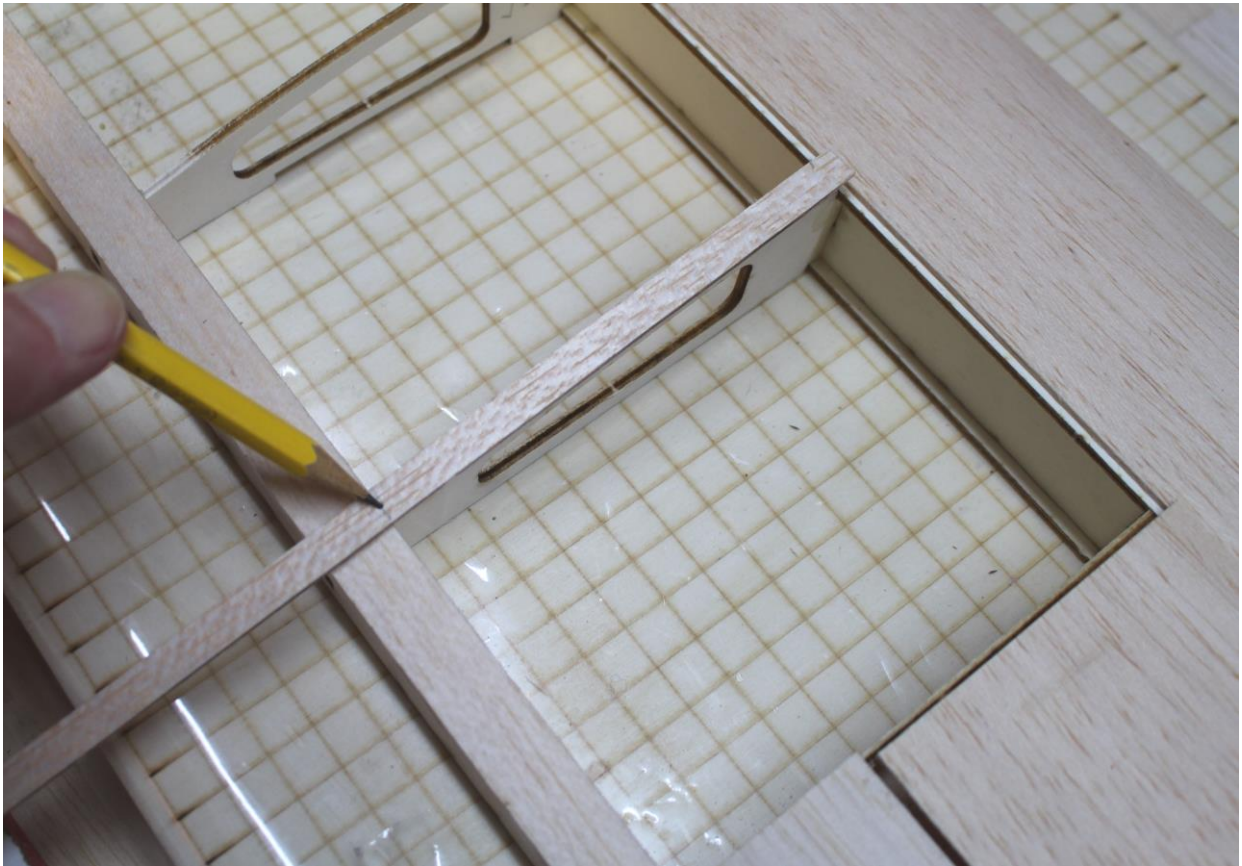
Rippenaufleimer (Brett P) ablängen und verleimen
