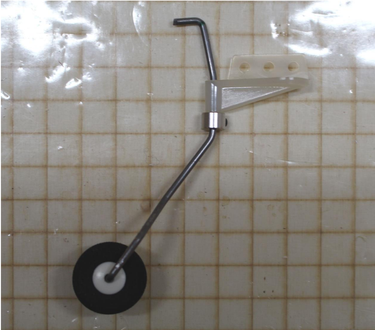
Fahrwerk am Rumpf mit 2× Schraube M3×16 mm am Rumpf verschrauben
