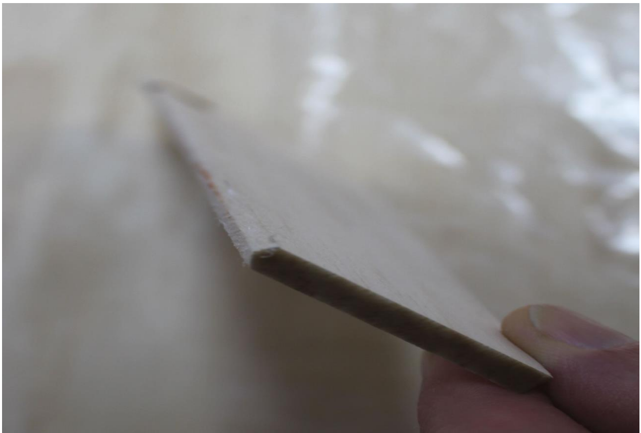
Vorderkante des Seitenruders (N7) spitz (ca. 90°) zuschleifen
