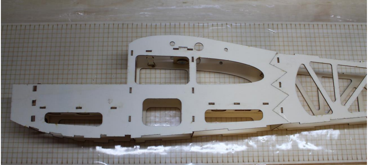
Zweites Rumpfseitenteil auf Spantengerüst auflegen und verleimen
