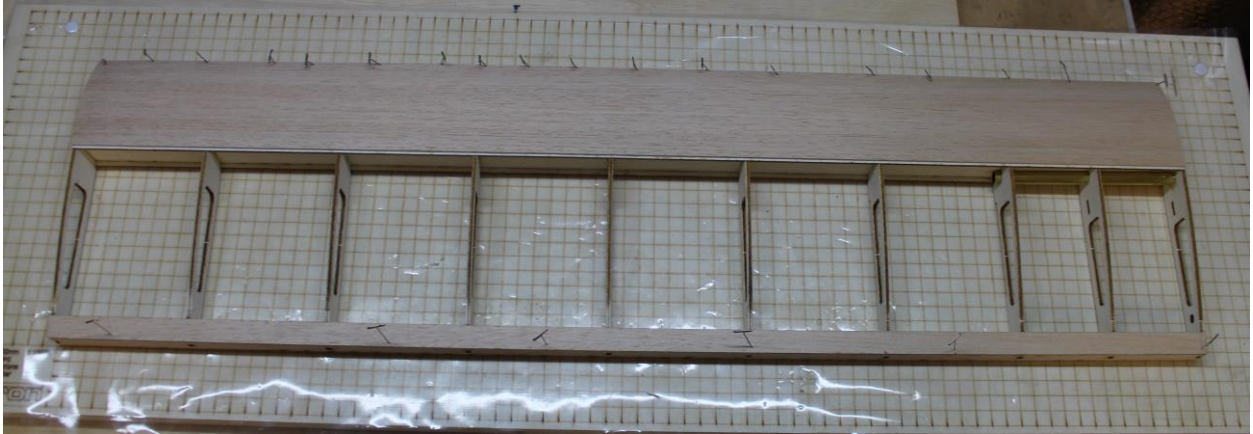
Nasenbeplankung 760×75 mm (1,5-mm-Balsa) zuschneiden und verleimen Endleistenbeplankung 760×15 mm (1,5-mm-Balsa) verleimen
