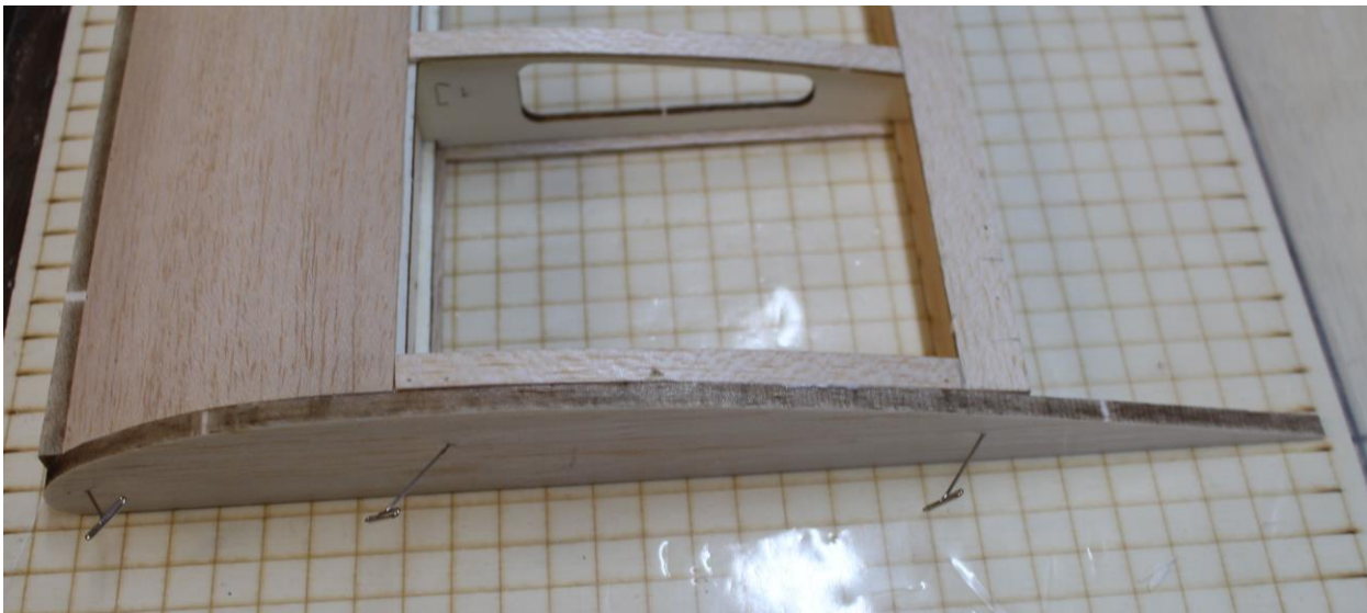
Abschlussrippe (G) an Endrippe (J1) verleimen
