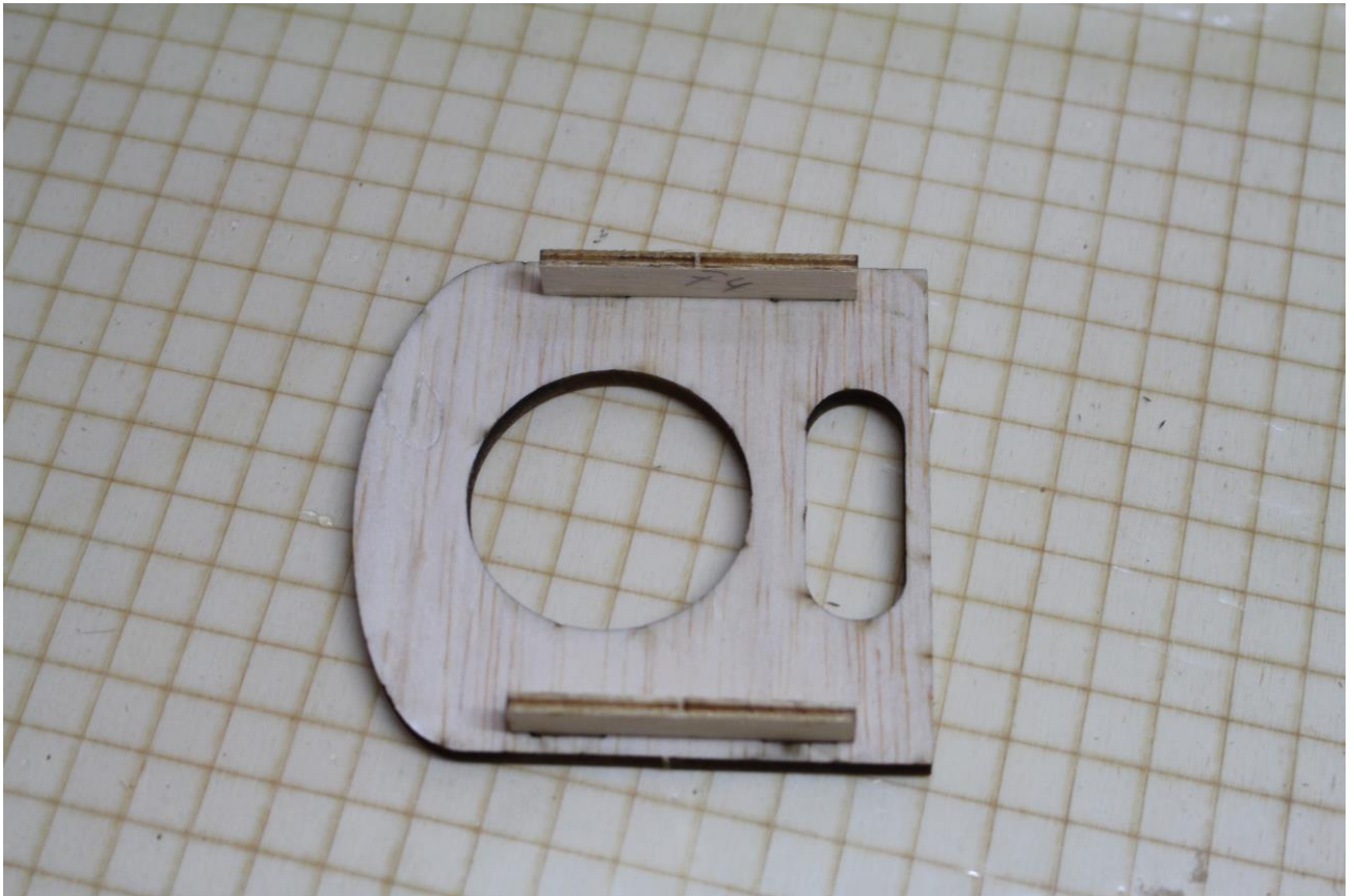
Laschen (F4) mit Frontverkleidung (G) verleimen
