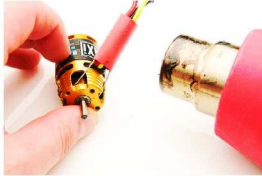
Nasuňte bužírku na pružinku s kabely a horkovzdušnou pistolí smrštěte. Slide the tube onto the spring with the cables and shrink with a hot air gun.
