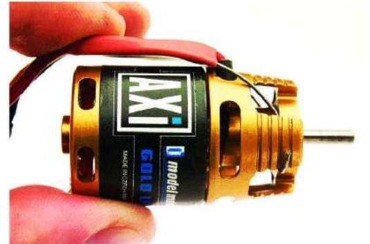
Takto to má vypadat. Pružinka odtlačuje kabely od rotačního pláště motoru a zamezuje jejich prodrění. This is what it should look like. The spring pushes the cables away from the rotating casing and prevents them from abrasion.
