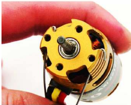
Zahákniěte konce pružinky. Hook the ends of the spring.
