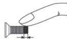
T43 Glue width : approx. 1mm T43 上膠寬度約 1mm
