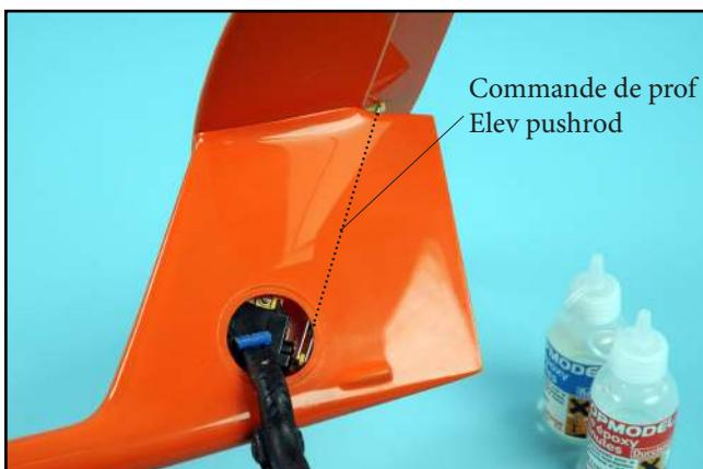
8) Dans cet ordre: connecter la tringlerie au guignol de profondeur, encoller la zone de collage du servo, insérer la rallonge puis le servo dans le fuselage, connecter la chape au palonnier puis immobiliser le volet de profondeur au neutre.
