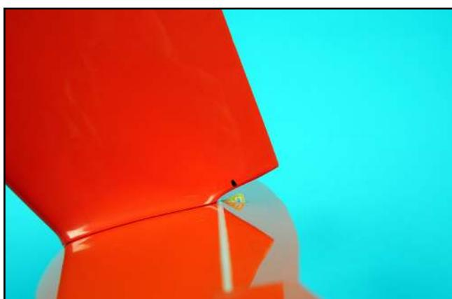
4) Visser le stab sur le fuselage et repérer la position de la sortie de la commande de profondeur.
