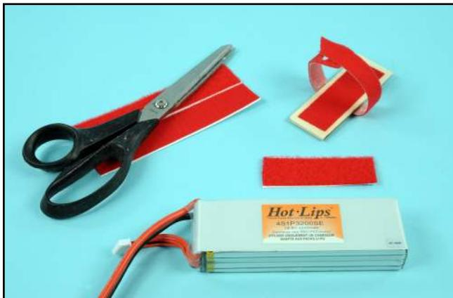
2) Nous conseillons de réaliser un petit support accu en CTP sous lequel on collera une sangle velcro® et sur lequel l'accu sera immobilisé avec un morceau de bande velcro®.
