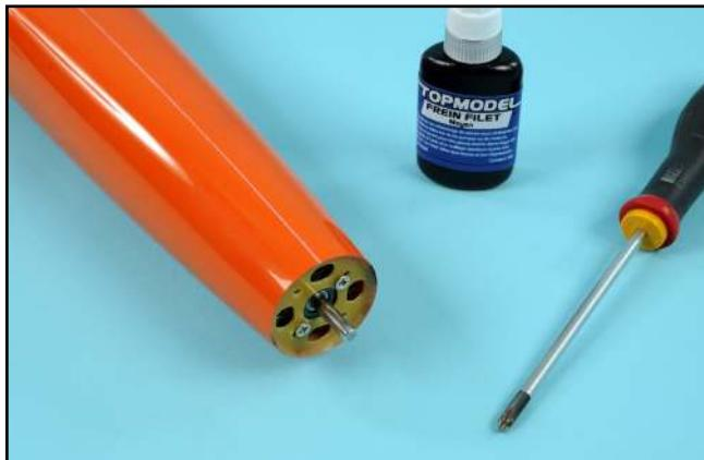
12) Visser le moteur sur le couple. Ne pas oublier le frein filet ! Attention à la longueur des vis, celles-ci ne doivent pas être trop longues pour ne pas endommager le moteur !
