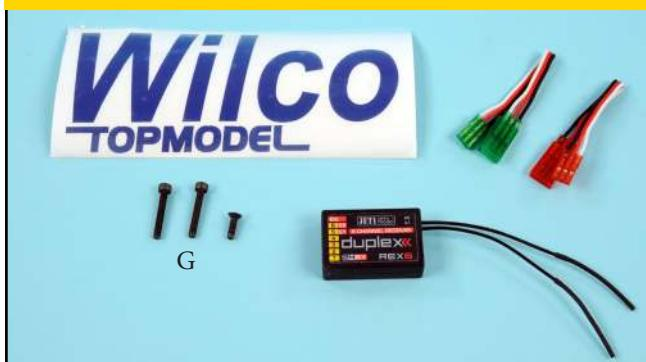
1) Connecter les rallonges d'ailerons de 10 cm au récepteur et le fixer dans le fuselage à l'aide d'un morceau de bande velcro®.
