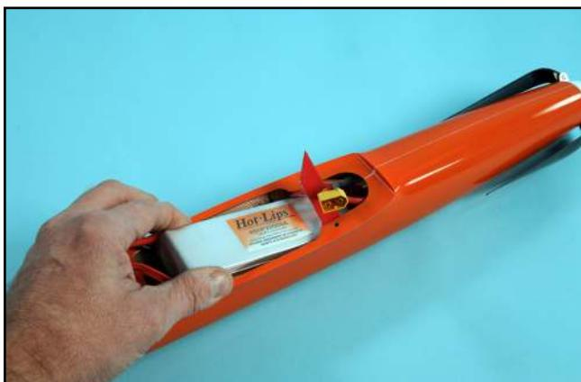
3) L'accu protégé par du scotch d'emballage, l'ensemble sera positionné et collé dans le fuselage en fonction du centrage. L'accu, soumis à de fortes accélérations, ne doit en aucun cas pouvoir bouger pendant le vol !
