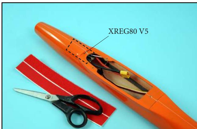
13) Fixer le contrôleur à l'aide d'un morceau de bande Velcro® (non fourni).
